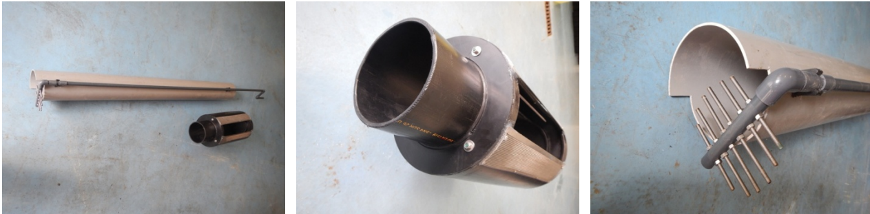
Foto 5/6/7; Mortbox snoekbaars, inclusief inlaat rooster tegen inzwemmende vis
